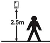
Используя прилагаемые крепления, закрепите заднюю панель на стене на высоте 2,5 м от пола. Для оптимальной производительности устройство не должно располагаться близко к вытяжке воздуха.
