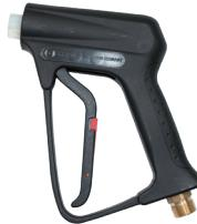
Пистолет высокого давления ECOLINE (GRASS vers.) Эргономичная ручка, фиксатор курка. Вход 22x1,5 П. Выход 1/4 М. Максимум: 250 бар, 45 л/мин., 150°С. Производитель: Германия, R+M
