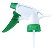
Более мощный пластмассовый насос-распылитель курковый для фляконов. Режимы работы: распыление, струя. Высота юбки 14 мм, диаметр 25 мм.
